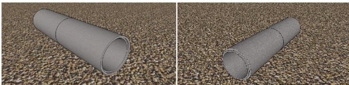
**Figura 11** - Tubulações de concreto armado do tipo macho e fêmea
